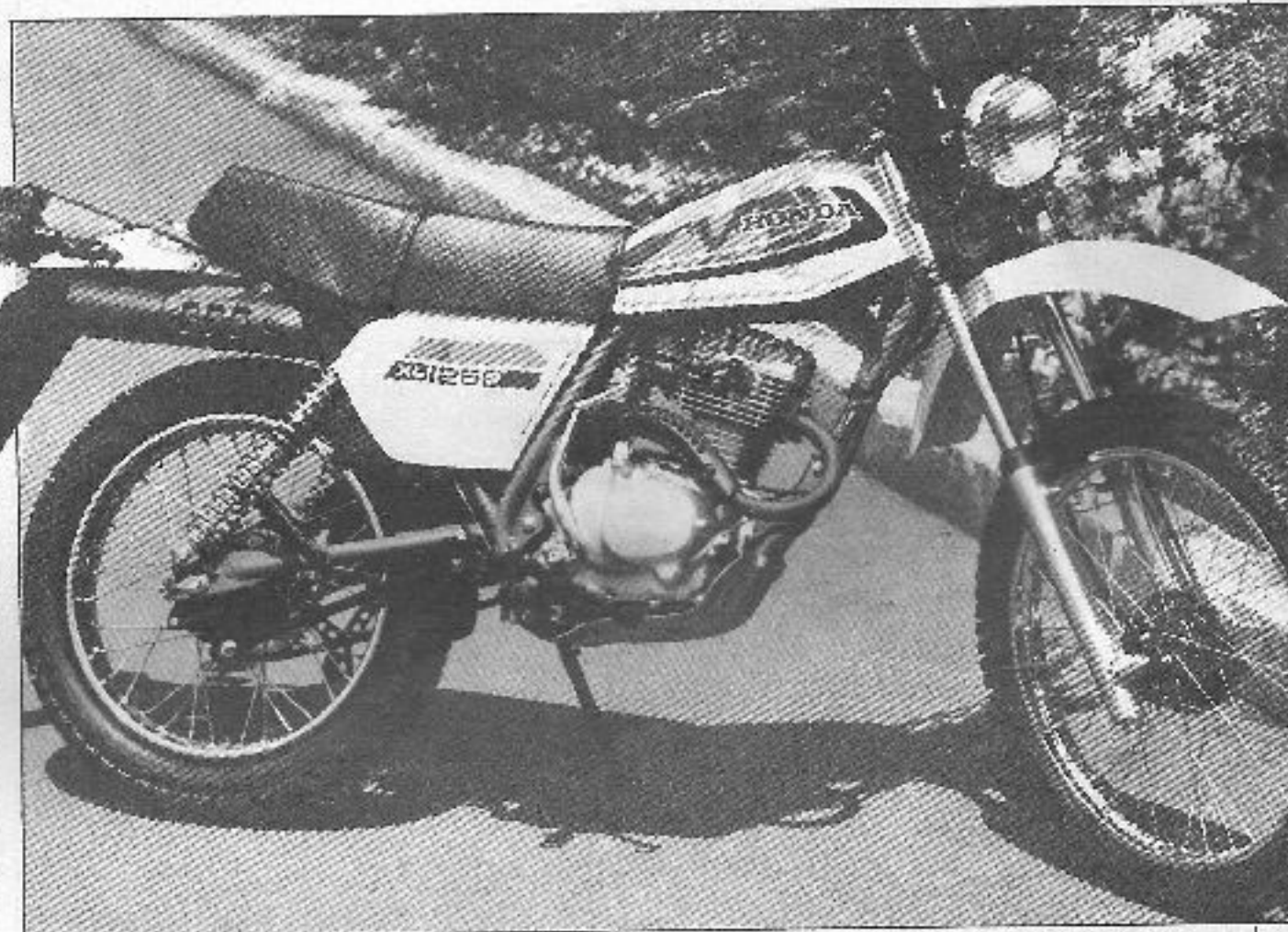
1/ La fourche BETOR, avec les fourreaux en magnésium, SVP !
