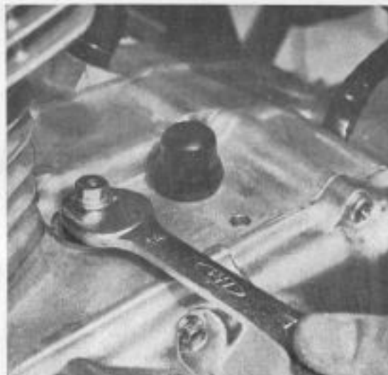
Débloqué de la douille fileté du tendeur de la chaîne de distribution avec une clé de 14 mm (Photo RMT)
