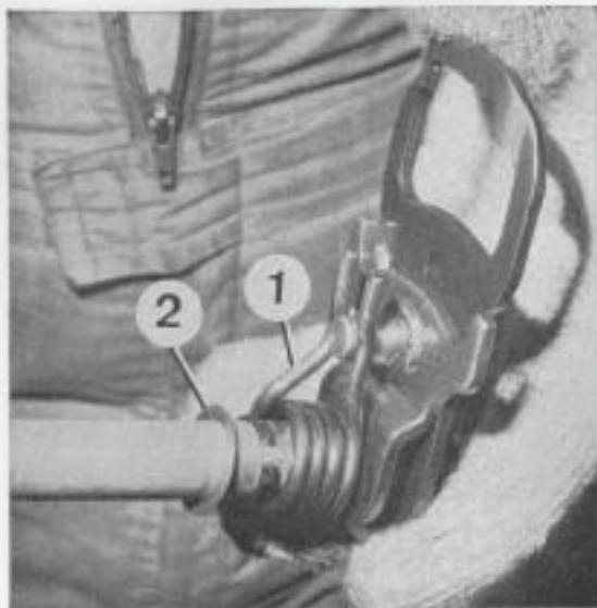
Position de montage du ressort en épingle de rappel du bras de sélection et présence de la rondelle (Photo RMT).
